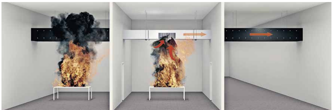
Brandbelastung von aussen
