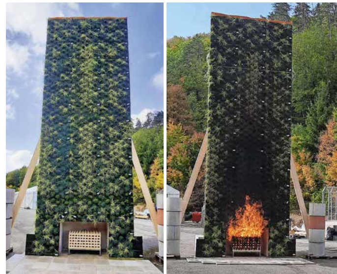
Die neue Fassadenkonstruktion mit Steinwoll-Substrat hat in Brandschutztests die Erwartungen erfüllt.
