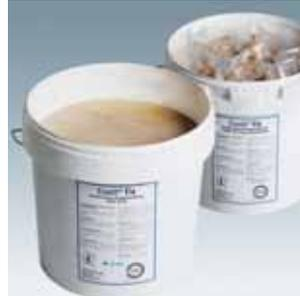
Wasserglas-Kaolin-Kleber, rein anorganisch, nicht brennbar A1. Verarbeitbar ab ca. +5 °C (Conlit Fix) bzw. -7° C (Conlit Fix Cold). Zur Verklebung der Stosstellen von Conlit Platten und Conlit Schalen.
