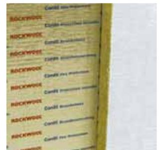
Hochverdichtete Platte. Vorderseite mit weißem Glasvlies, Rückseite mit gitternetzverstärkter, farbig gekennzeichnete Aluminiumfolie beschichtet. Erstellen von bauseitig beschichtungsfreien Weichschottsystemen für Rohr-, Kabel- und Kombiabschottungen S30 – S90.
