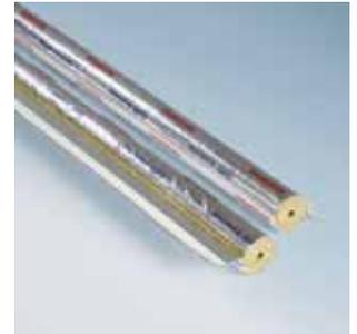
Konzentrisch gewickelte, druckfeste, formbeständige Brandschutzschale, mit farbig gekennzeichnete Alubeschichtung. Rohrabschottungen S30 bis S90 von brennbaren und nicht brennbaren Rohrleitungen durch Decken und Wände in Massiv- und Leichtbauweise.
