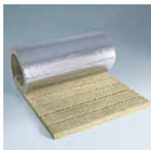
Lamellmatte mit einseitiger Alubeschichtung. Verkleidung von Lüftungskanälen und Lüftungsrohren, Leitungen und Behältern verschiedener Art mit Medientemperaturen  $\leq 250^\circ\text{C}$ .
