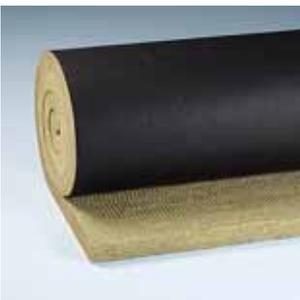
Einlagige Brandschutzbekleidung EI30 und EI60 für Lüftungsrohre aus verzinktem Stahlblech. Geprüft nach der neusten Prüfnorm EN 1366-1:2014 inklusive Einbau durch leichte Trennwände.
