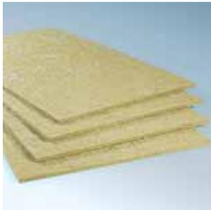
Druckfeste, formstabile Dämmplatte. Brandschutzbekleidung von Stahlunterzügen und Stahlträgern für die Feuerwiderstandsdauer von 30 bis 180 Minuten, respektive bei Stahlstützen von 30 bis 120 Minuten.
