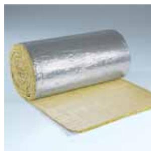
Lamellmatte mit einseitiger Alubeschichtung. Auf der Wollseite selbstklebend. Wärme- und Schalldämmung von Lüftungskanälen und Lüftungsrohren.
