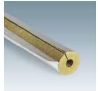
Druckfeste, formstabile Rohrschale mit Alubeschichtung. Brandschutzbekleidung von runden Stahlstützen und Windverbänden für die Feuerwiderstandsdauer von 30 bis 120 Minuten. Bekleidung von Feuerlöschleitungen bis 90 Minuten.
