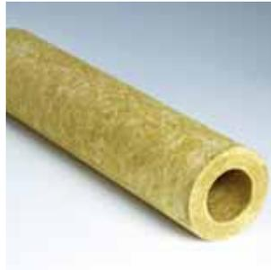
Konzentrisch gewickelte, unkaschierte Rohrschale. Einseitig aufgeschlitzt und auf der Innenwandung eingesägt. Für Rohrleitungen in Industrie- und Kraftwerksanlagen, Fernwärme- und Abgasleitungen im Hochtemperaturbereich.
