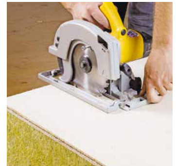
Einfaches Zuschneiden mit der Handkreissäge
