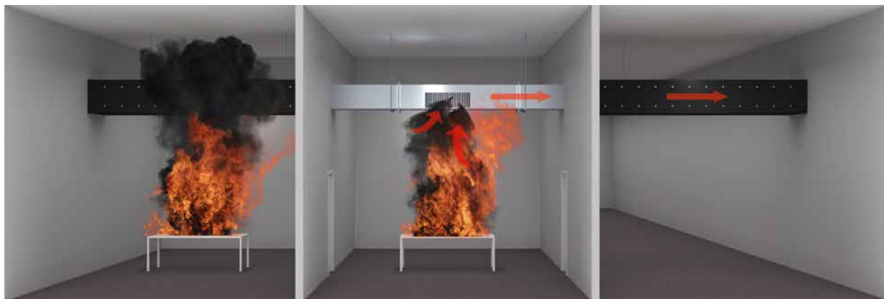
Charge combustible de l'extérieur (o -> i)
