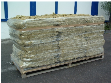
Laine de pierre Flumroc, en vrac sur palette à usage unique
