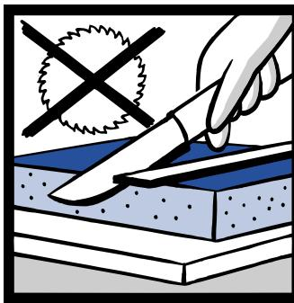
Tagliate i materiali isolanti su una superficie piana. Utilizzate un coltello con lama a taglio ondulato e non una sega.
