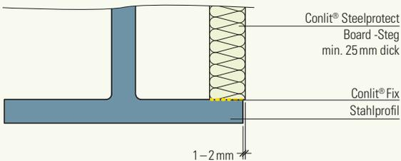
Das minimale Vorstehen der Stege gewährleistet einen optimalen Kontakt mit den Seitenplatten.
