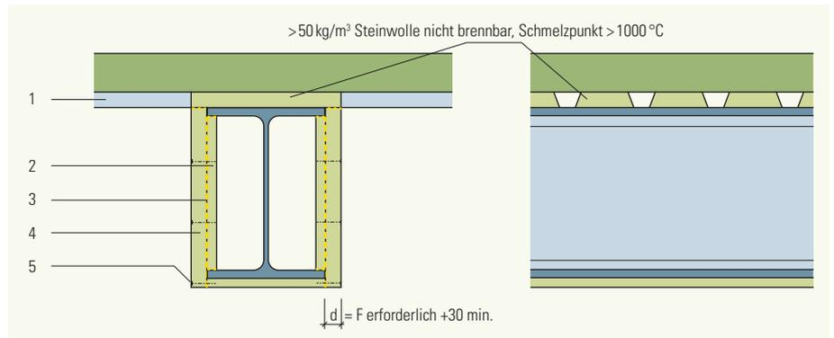
Verfüllung der Sicke und Anschlussdämmung  $b \geq 200$  mm
